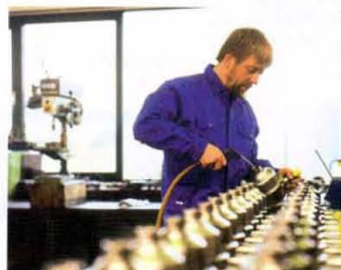
Bild 3: Ein Mitarbeiter der Mankenberg GmbH bei der Montage von Ent- und Belüftungsventilen
