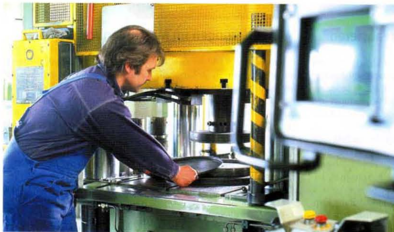
Bild 2: Beim Tiefziehen wird mit dem Stempel einer Presse der Blechzuschnitt durch den Ziehring gedrückt. Der Niederhalter verhindert die Bildung von Falten am Ziehteil.
