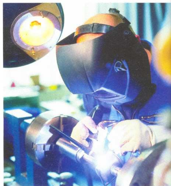
Die tiefgezogenen Hohlkörper werden mit den Anschlüssen verschweißt The deep drawn hollow bodies are welded with the connections
