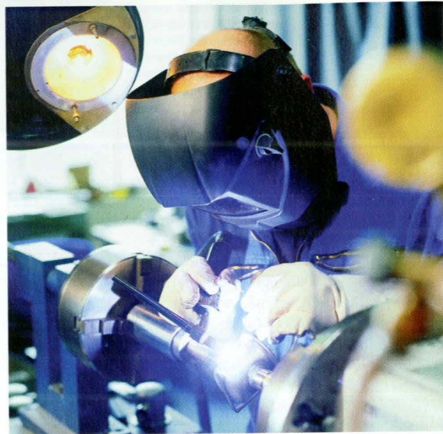
Die tiefgezogenen Hohlkörper werden mit den Anschlüssen verschweißt
